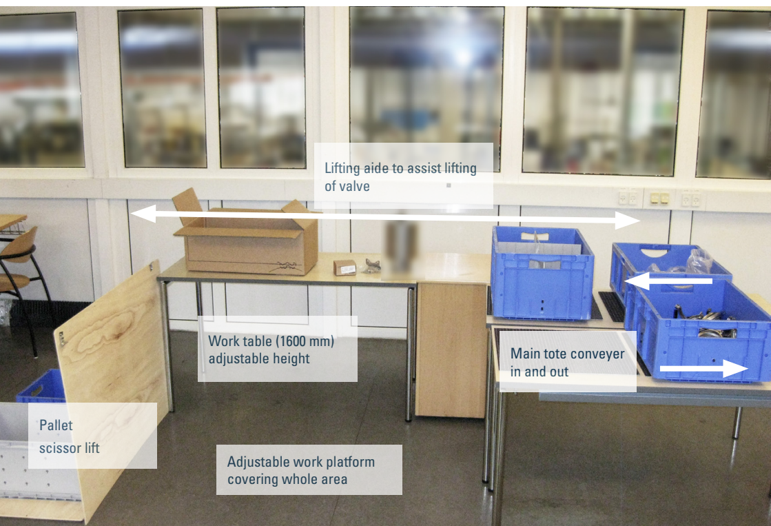
Mockup af de enkelte arbejdsstationer.
